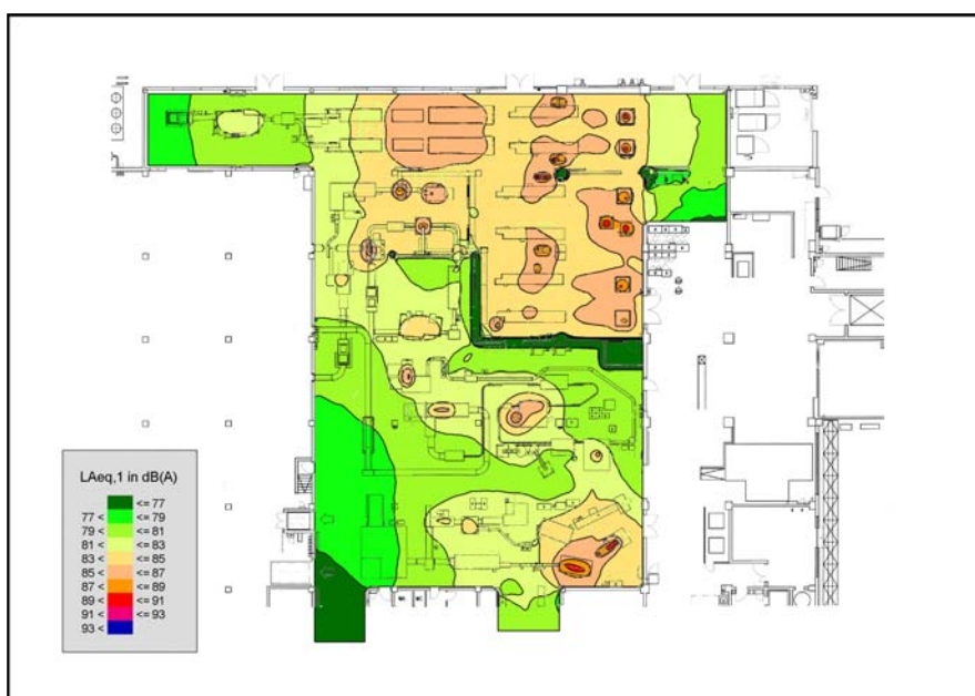
Prognose-Situation nach Durchführung von Lärmminde- rungsmaßnahmen in einer Produktionshalle
