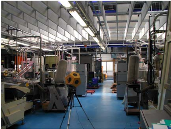
Überprüfung raumakustischer Maßnahmen
